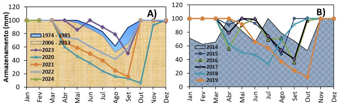
**Figura 6:** Armazenamento de água no perfil do solo (mm mês<sup>-1</sup>) do período de 1974-1985, 2006-2013, 2018, 2019, 2020, 2021, 2022 e 2023 (A) e dos anos de 2014, 2015, 2016 e 2017 (B) para a região do Sul de Minas, Muzambinho, MG.
